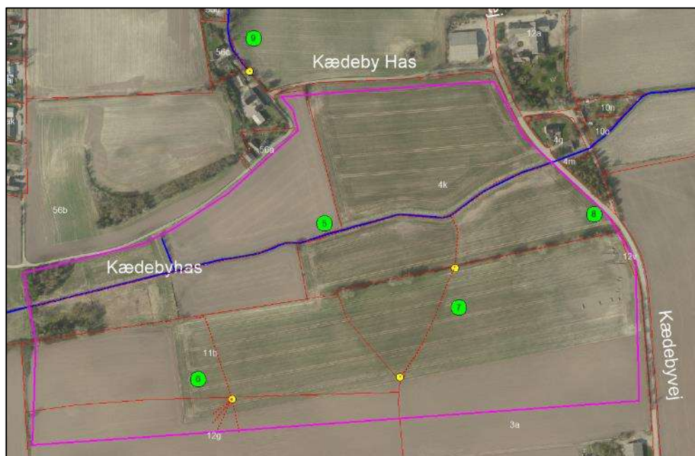
Figur 7: Afvandingssystemer, der afvander til delområdet Kædebyhas. Undersøgelsesområde (pink streg), numre for afvandingssystemer (grøn cirkel), brønde (gul cirkel), dræn (rød stiplest streg), vandløb (blå streg)
